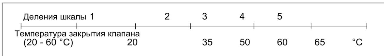
Рис. 6. Настройка клапана-ограничителя FJV.
