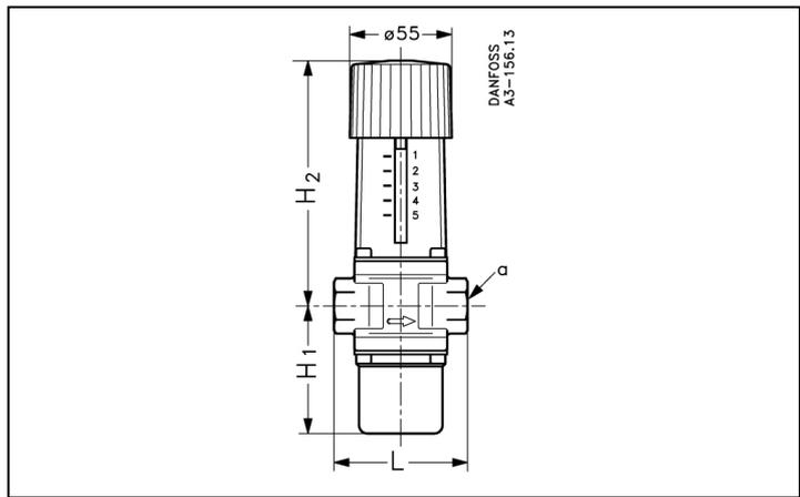
Рис. 4. Габаритные и присоединительные размеры клапана-ограничителя температуры FJV (с внутренней резьбой).
