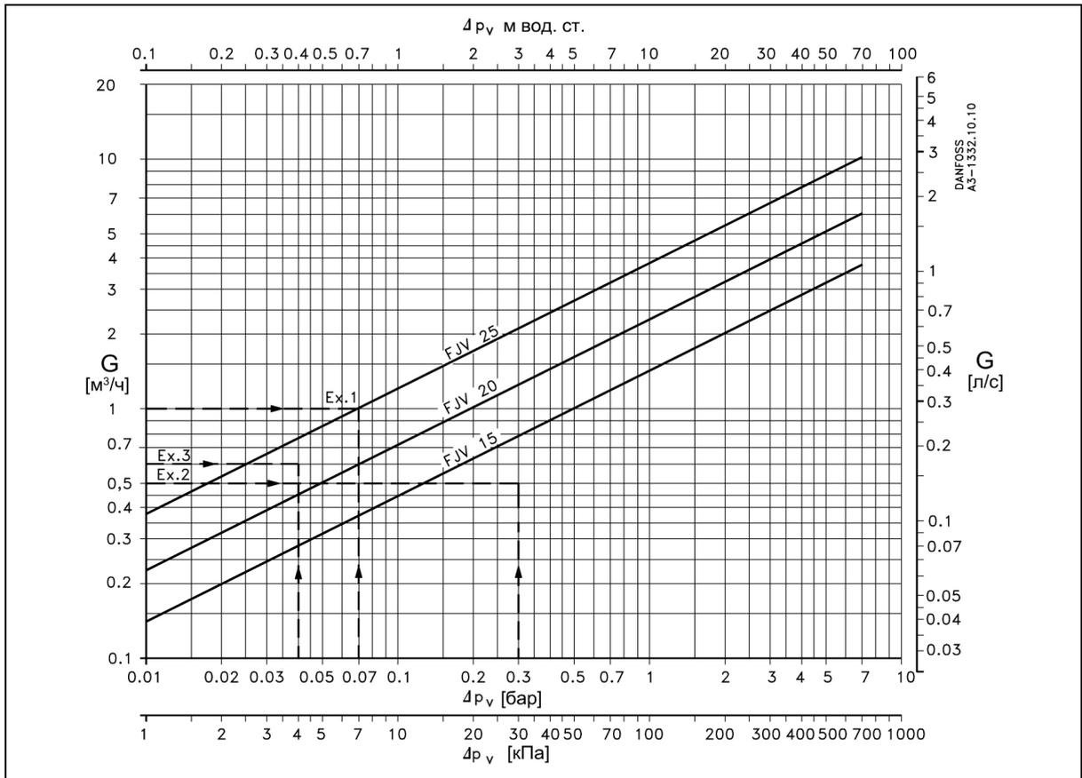
Рис. 3. Диаграмма для подбора клапана-ограничителя температуры FJV.
