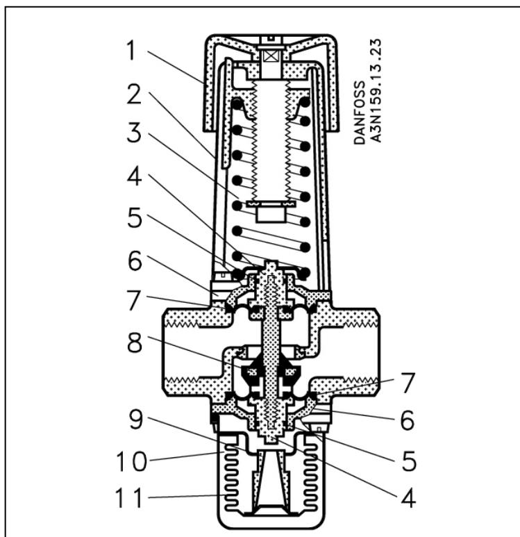
Рис. 2. Устройство клапана-ограничителя температуры возвращаемого теплоносителя FJV.
